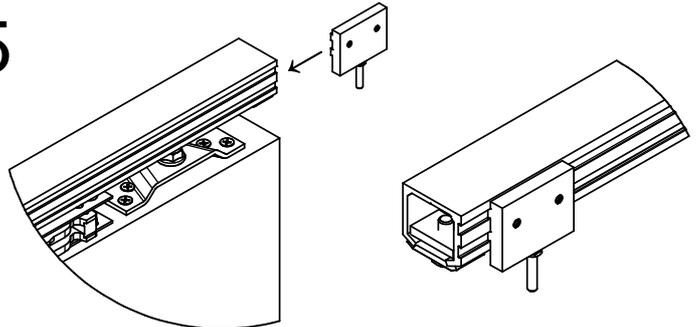
(Beide) Mitnehmer in die Laufschiene einschieben und bei den Stopperrn positionieren.
