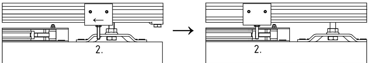
Mitnehmer in Dämpfer einschieben und Dämpfung aktivieren.
