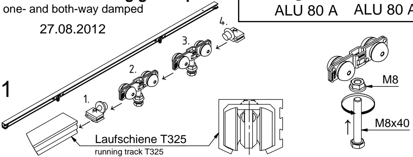
Stopper und Laufwagen wie abgebildet in die Laufschiene einschieben.
