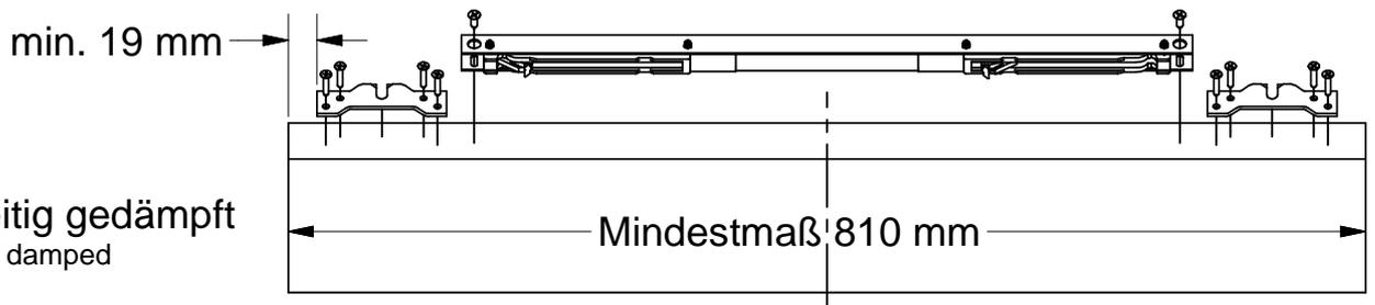
Dämpfer und Tragflansche positionieren und festschrauben.
